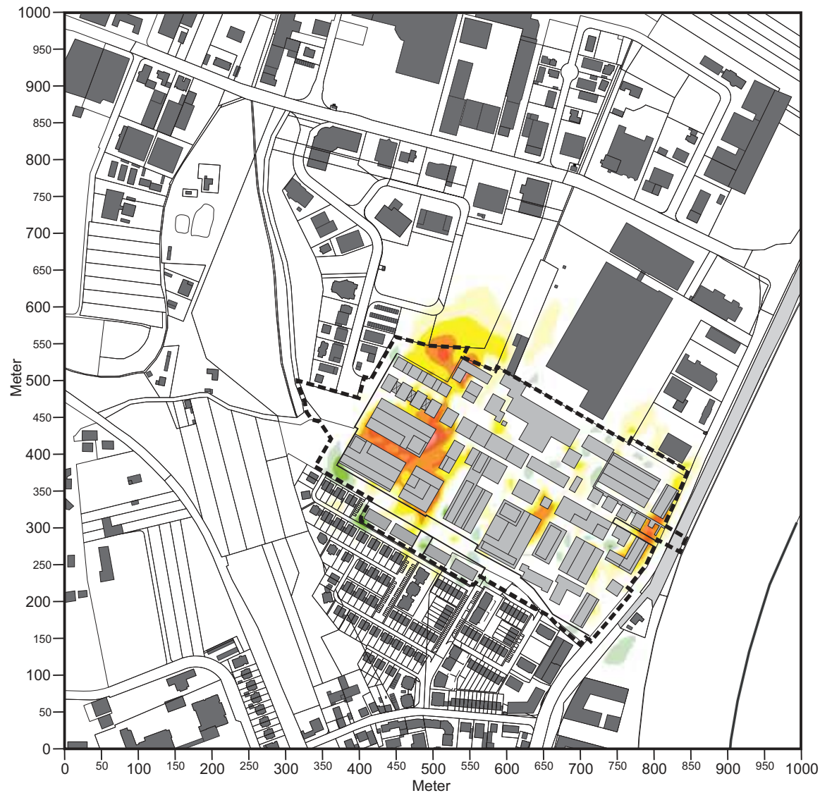
Abb. 16.3 Vorher-Nachher-Vergleich - Ergebnisse mikroskaliger Strömungssimulationen (Tagsituation mit labiler Luftschichtung). Planungsbedingte Veränderung der Windgeschwindigkeit 2 m ü.G. Windanströmung aus Südsüdwesten (210°) mit 2.5 m/s in einer Höhe von 10 m ü.G.
