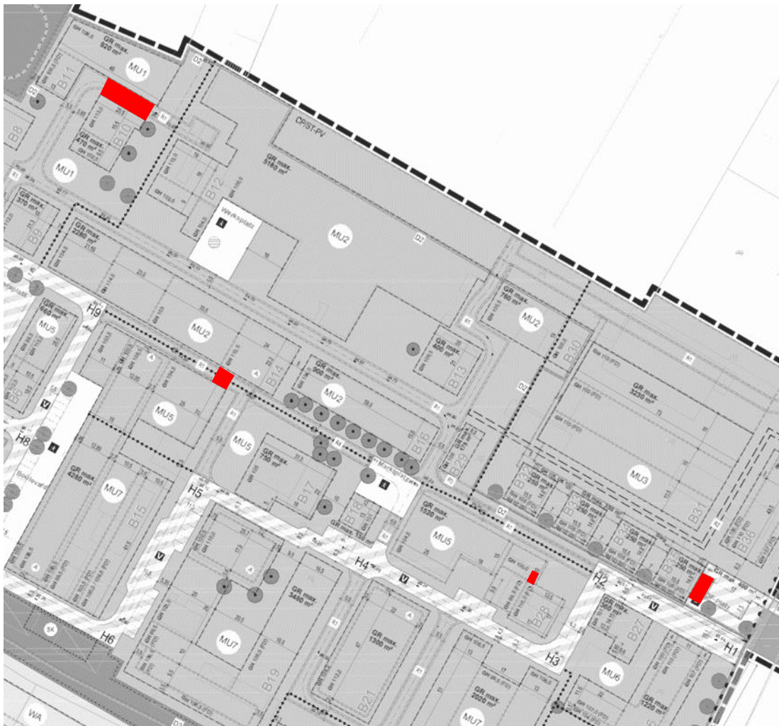
Bereiche (rote Markierung), in denen zur Umsetzung des Rahmenplans eine Reduzierung der Tiefe der Abstandsflächen notwendig ist (ohne Maßstab)
